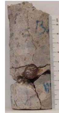
Bild links: Bohrkern aus Bodenplatte mit Trennrissen im Beton
