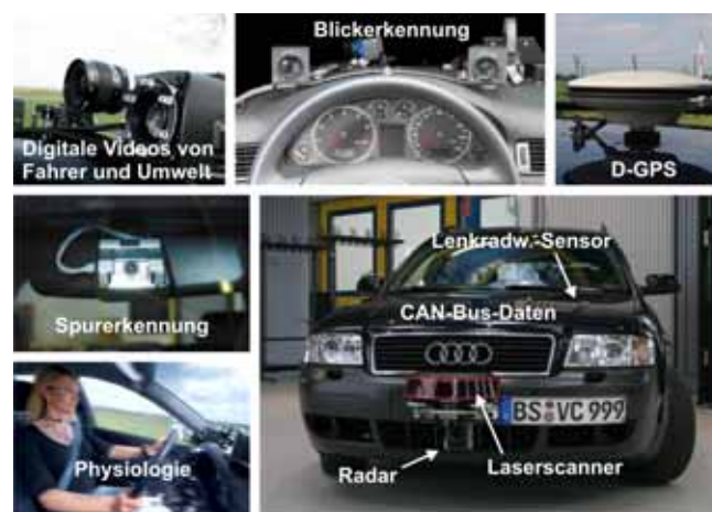
Abbildung 4-1: Instrumentiertes Versuchsfahrzeug DLR-ViewCar.
