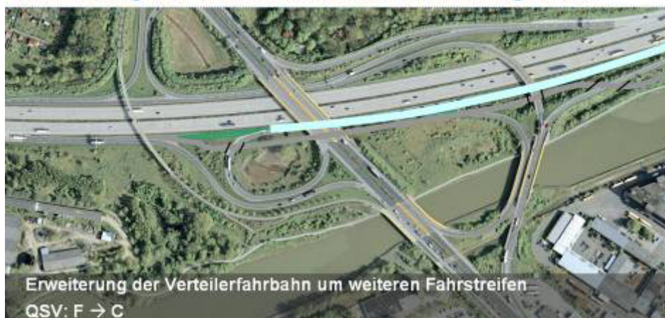
Abbildung 6-14: Maßnahme Verteilerfahrbahn erweitern – AS Hannover-Herrenhausen.
