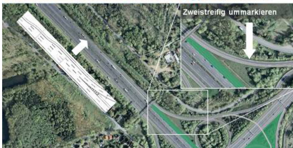
Abbildung 6-17: Maßnahme Verteilerfahrbahn erweitern – AK Hannover-Buchholz.
