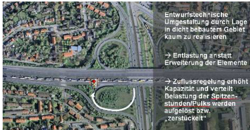
Abbildung 6-18: Maßnahme Zuflusssteuerung – AS Hannover / Langenhagen.
