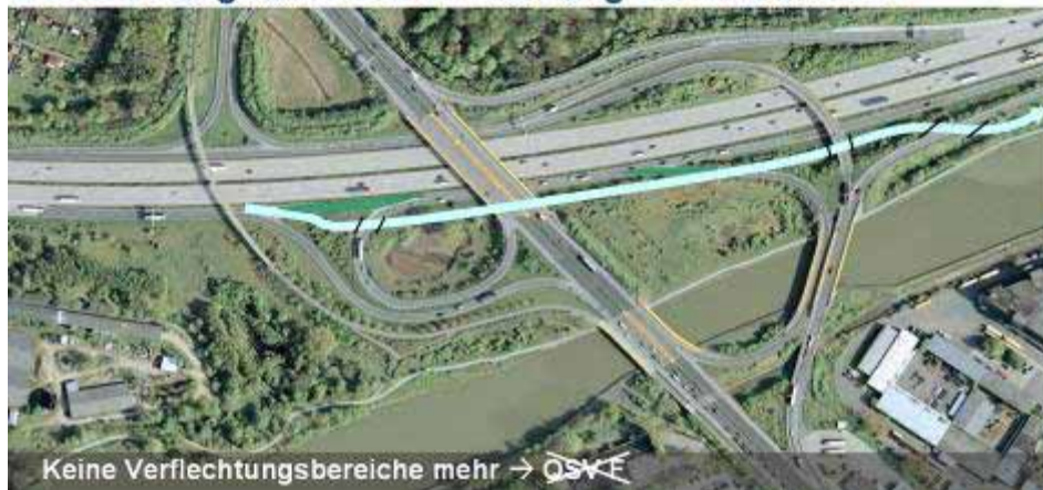
Abbildung 6-13: Maßnahme Verflechtungsbereiche auflösen – AS Hannover-Herrenhausen.
