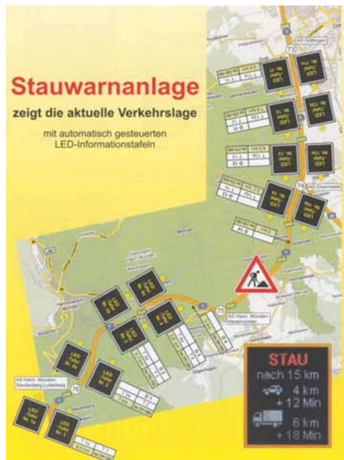
Abbildung 6-3: Mobile Stauwarnanlage auf der A7 (Quelle: B.A.S.)
