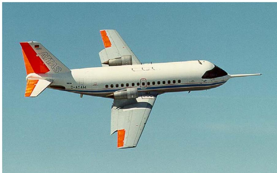
Bild 3: ATTAS mit aktiven Direkt-Auftriebsklappen
