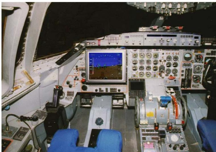
Bild 6: Sitz des Experimental-Piloten mit Sidestick und 3D-Display für A400-M
