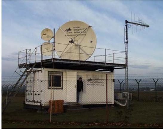
Bild 4: Mobile Telemetriestation für Flugversuche
