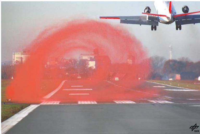
Bild 5: ATTAS im Einsatz für die Wirbelschleppen-Forschung
