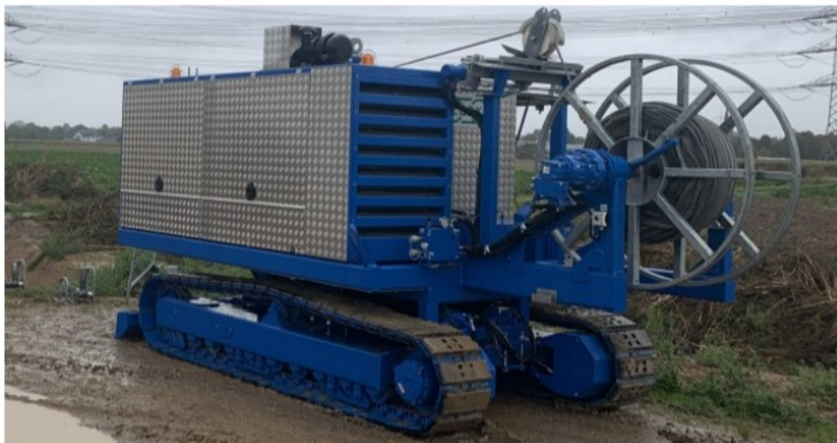
Abbildung 19: Beispiel für ein Kabelzugerät auf selbstfahrendem Raupenfahrwerk, Quelle: Amprion GmbH
