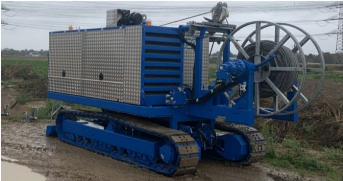
Abbildung 15: Beispiel für ein Kabelzugerät auf selbstfahrendem Raupenfahrwerk, Quelle: Amprion GmbH
