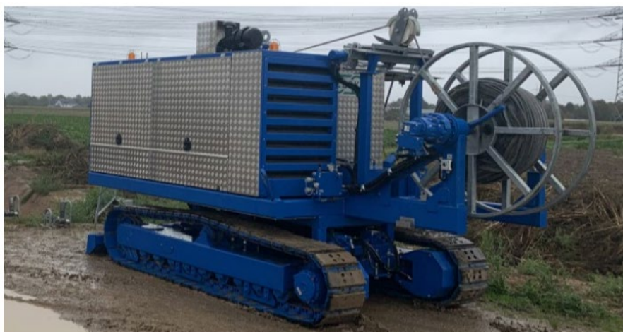
Abbildung 24: Beispiel für ein Kabelzugerät auf selbstfahrendem Raupenfahrwerk, Quelle: Amprion GmbH
