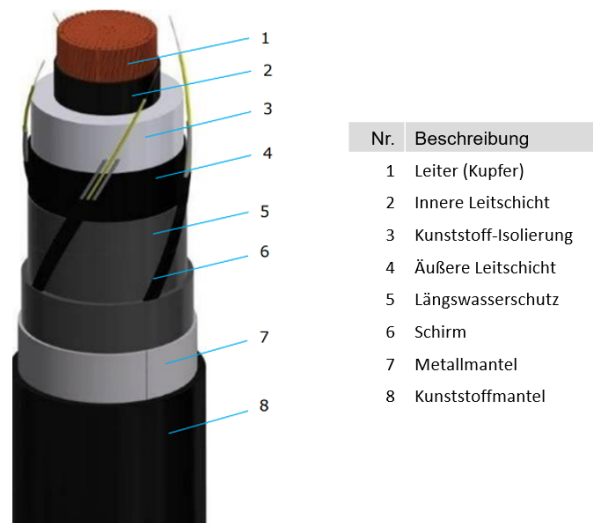
Abbildung 7: Beispielhafter Kabelaufbau eines 525 kV-Energiekabels (Gleichstrom), Quelle: Prysmian
