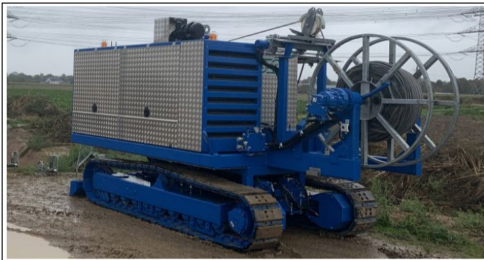
Abbildung 16: Beispiel für ein Kabelzugerät auf selbstfahrendem Raupenfahrwerk, Quelle: Amprion GmbH
