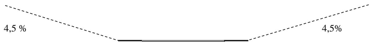
Abb. 3: Prinzipskizze der Landefläche Abflugsektoren (Längsschnitt)
