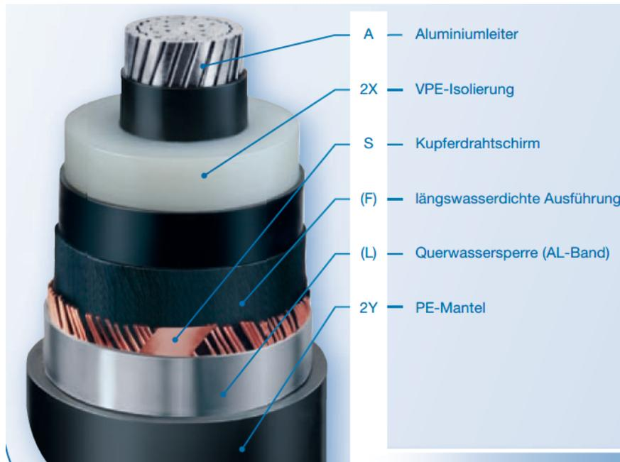
Abbildung 10: Kabel mit Aufschlüsselung der Bezeichnung N(A)2XS(FL)2Y, (Quelle: nkt cables)
