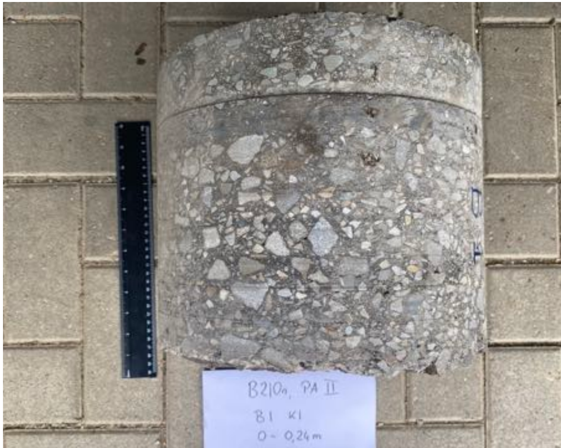
Foto 1: Asphaltkern B 1, K 1, 0 – 24 cm
