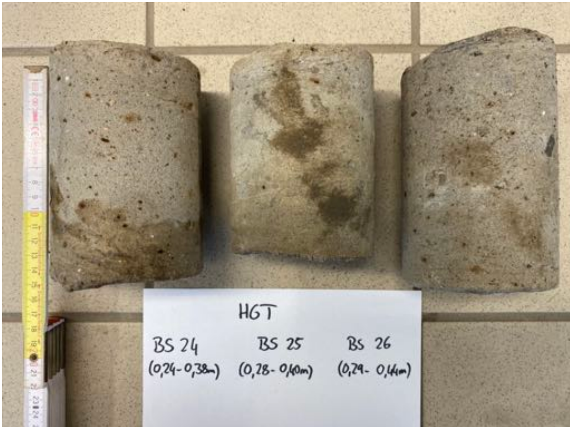
Foto 11: Kerne hydraul. gebundene Tragschicht, BS 24 bis BS 26, Tiefen s. Bild
