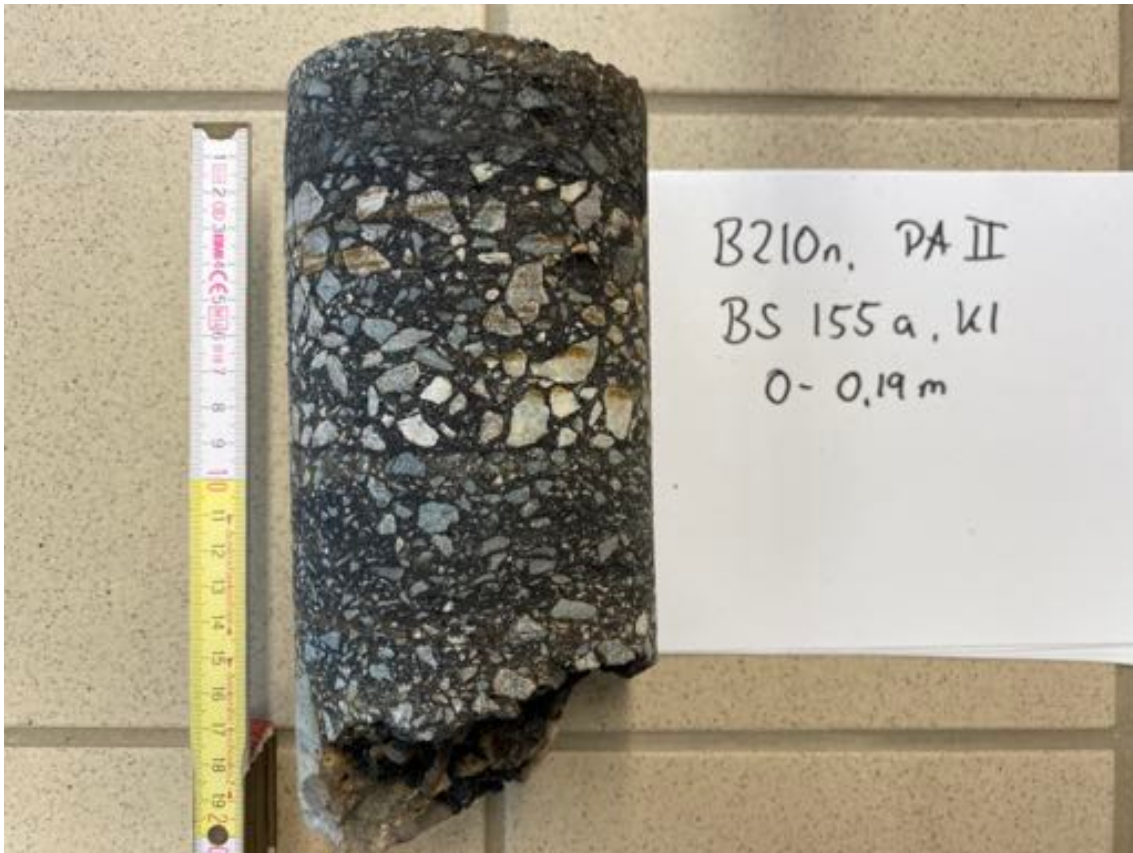
Foto 17: Asphaltkern BS 155a, K 1, 0 – 19 cm
