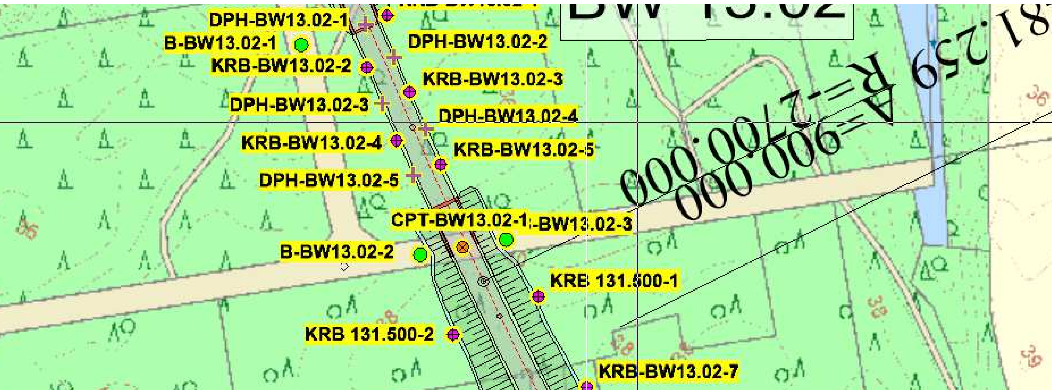
Abbildung 2: Zusätzliche Bohruntersuchungen entlang der geplanten Grünunterführung im Ketzendorfer Forst.
