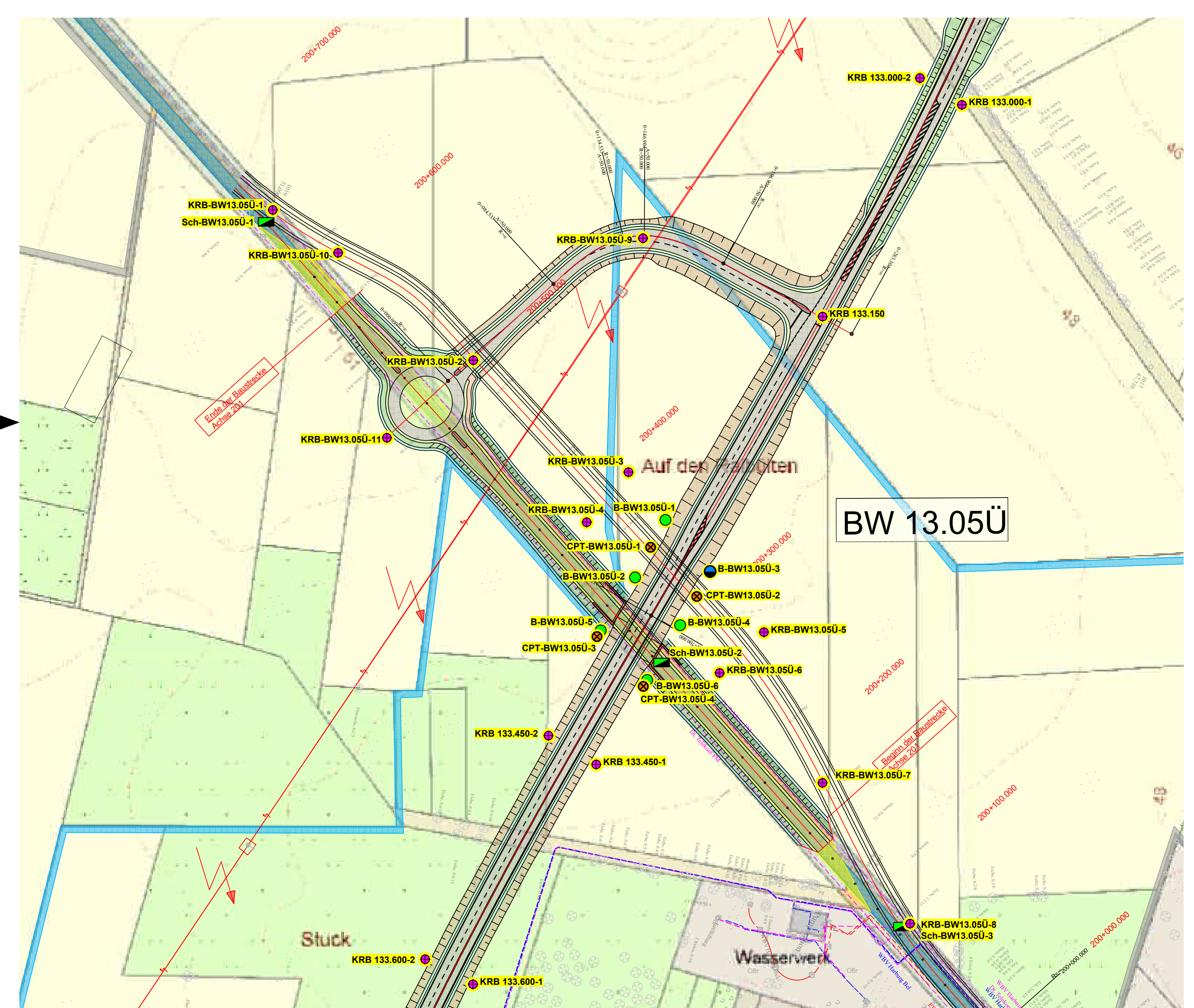
Abbildung 2: Ausschnitt des Erkundungsrasters im Bereich des Brückenbauwerks BW13.05Ü.
