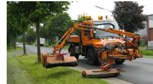
Unimog U-400 mit Mähkombination im Einsatz
