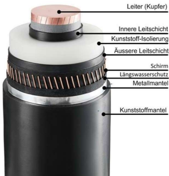
Abbildung 8: Beispielhafter Kabelaufbau eines 320 kV-Energiekabel (Gleichstrom), Quelle: ABB
