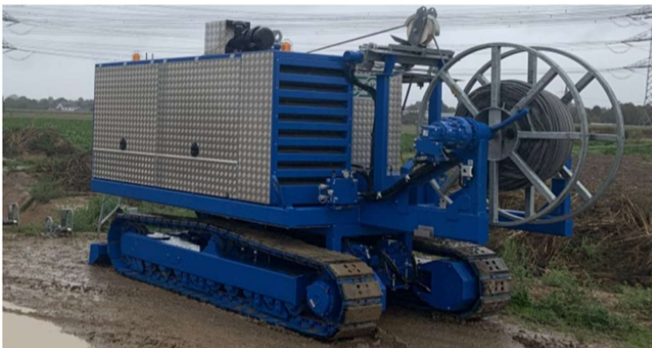
Abbildung 17: Beispiel für ein Kabelzuggerät auf selbstfahrendem Raupenfahrwerk, Quelle: Amprion GmbH
