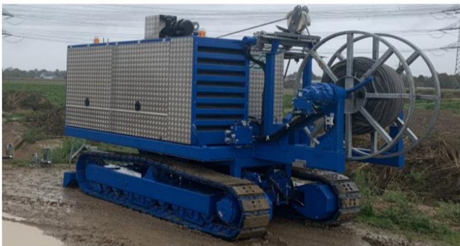
Abbildung 16: Beispiel für ein Kabelzuggerät auf selbstfahrendem Raupenfahrwerk, Quelle: Amprion GmbH
