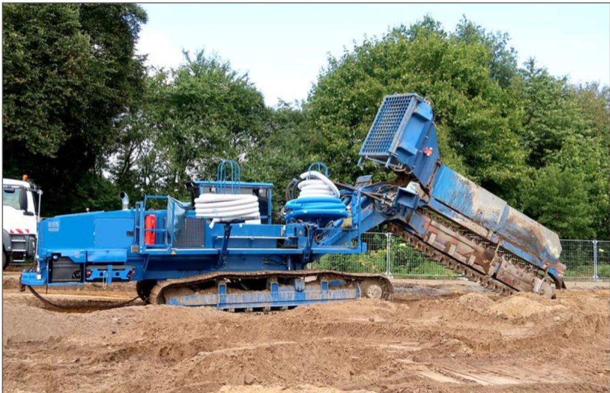
Abbildung 41 Drainagefräse (Quelle: ARGE Amprion-Legden-Asbeck)
