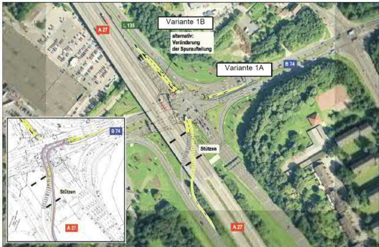
Abb. 3-10 Plangleiche Maßnahmen zur Steigerung der Leistungsfähigkeit Verteiler Ihlpohl 15
