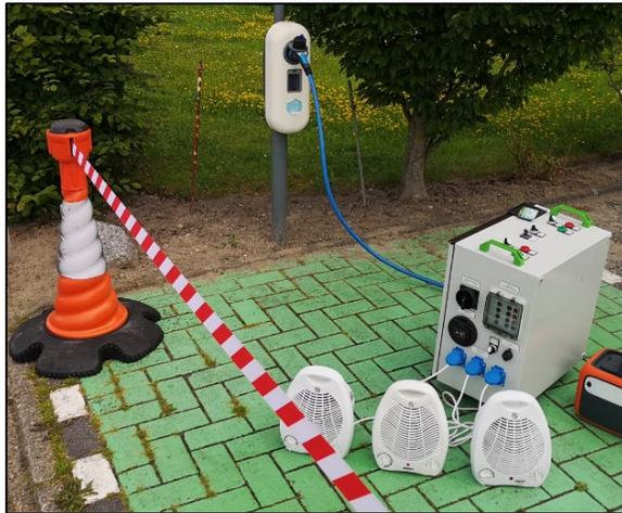
Abb. 11: Messtechnische Prüfung einer AC-Ladeeinrichtung
