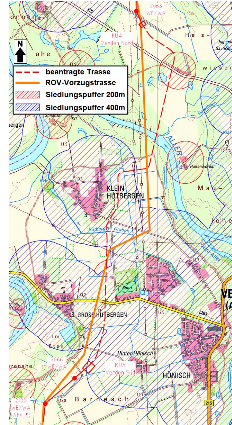
Abbildung 12: Abweichung im Bereich Erdkabelabschnitt Verden
