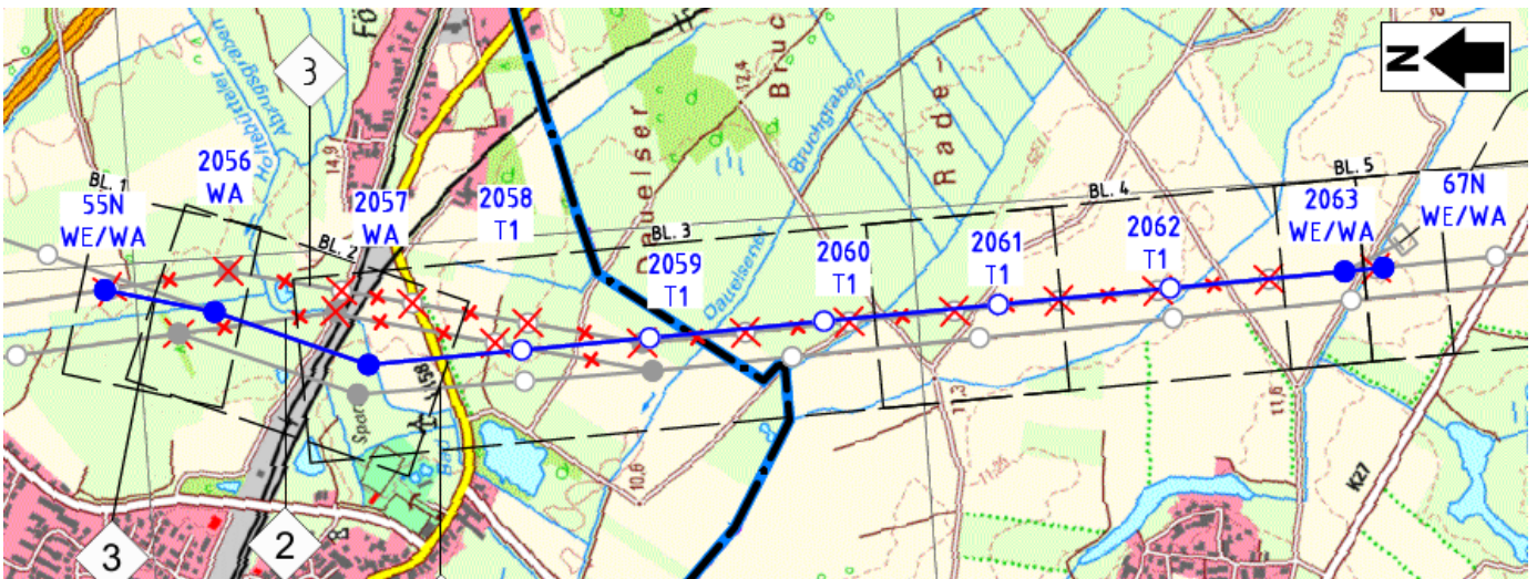
Abbildung 51: Leitungsmitnahme der 110-kV-Leitung LH-10-1006 (Avacon Netz GmbH)
