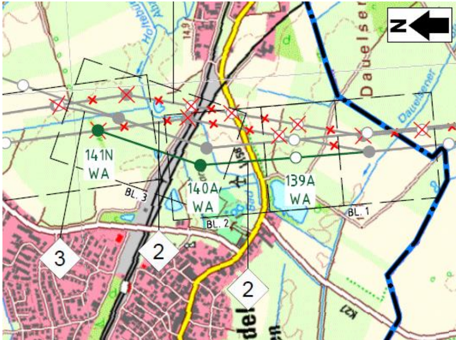
Abbildung 16: Verlegung der 380-kV-Bestandsleitung LH-10-3003 östlich von Langwedel
