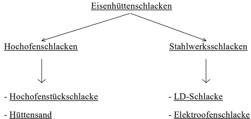
Hochofenschlacken und Stahlwerksschlacken werden dem Abfallschlüssel 1002 02 (unverarbeitete Schlacke) zugeordnet.
