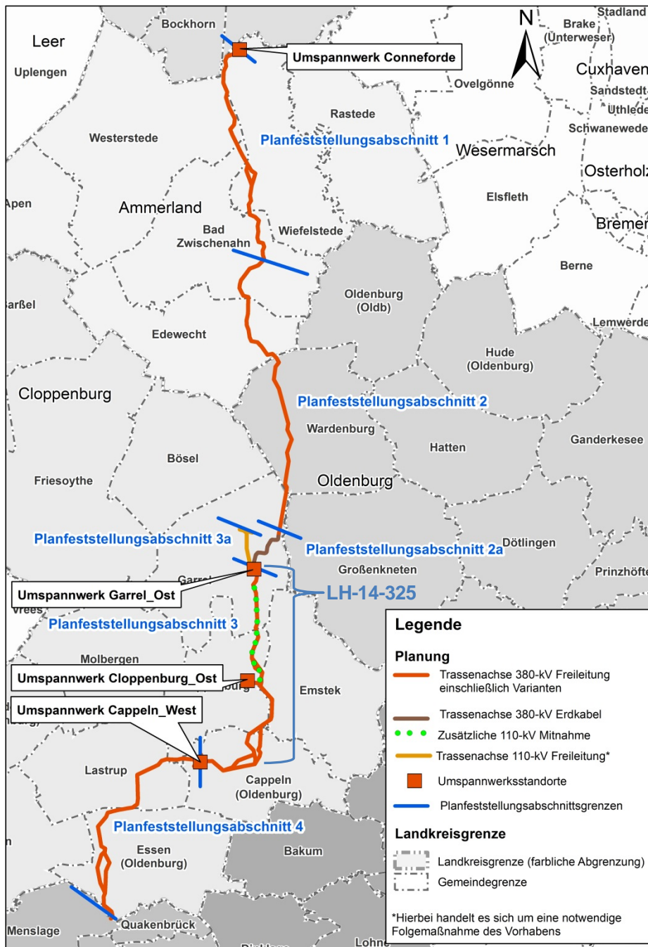
Abbildung 2: Planfeststellungsabschnitte 380-kV-Leitung Conneforde – Cloppenburg – Merzen
