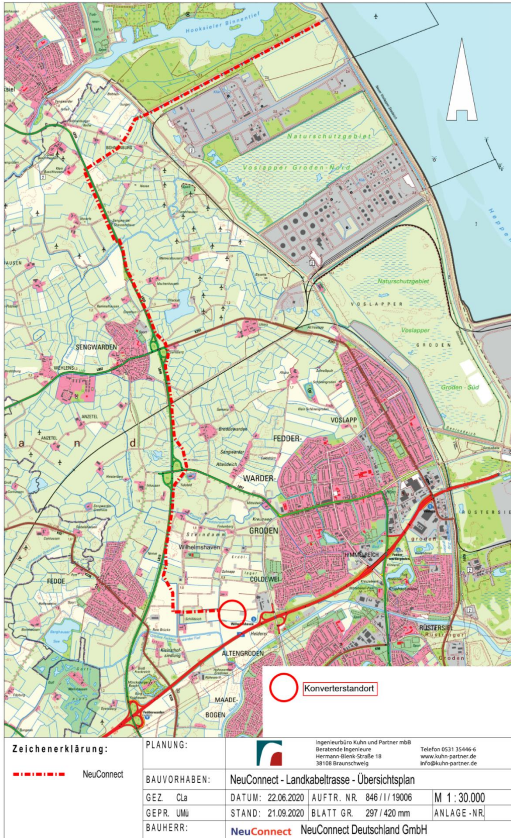
Abbildung 42: Trassenverlauf vom Anlandungspunkt zum Konverterstandort
