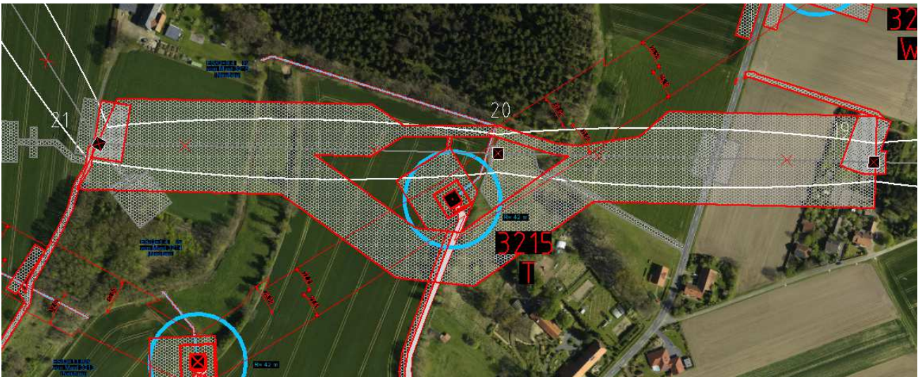
Abbildung 22: Verlauf des Kabelprovisoriums nördlich des Mastes Nr. 20 der LH-10-2010
