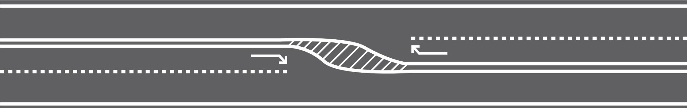
2+1 bedeutet, dass die Fahrbahn abwechselnd in einen bzw. zwei Fahrstreifen je Fahrtrichtung unterteilt ist.
