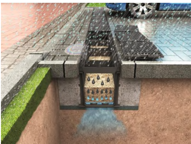
Abbildung 3: Systemdarstellung der geplanten Versickerungsmulde D-Rainclean
