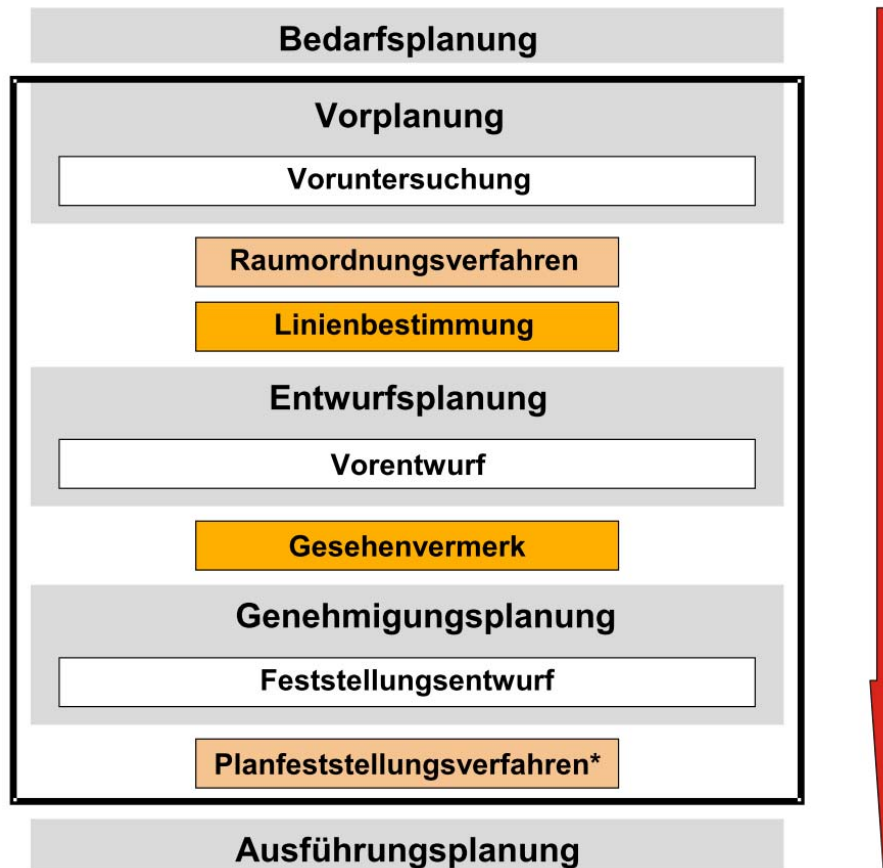
Bild I-1: Übersicht Planungsprozess: Planungsstufen mit Ergebnissen und Verfahrensschritte
