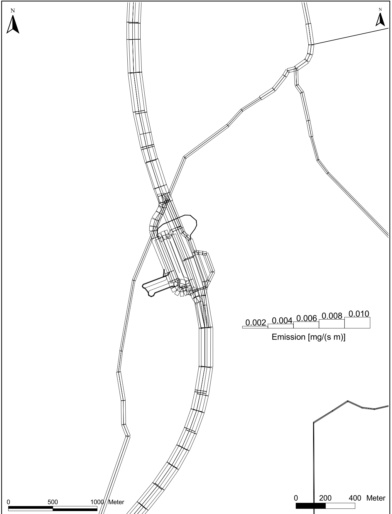
Abb. A3.2: Mittlere PM10-Emissionsdichte auf dem Straßennetz im Untersuchungsgebiet für den Planfall
