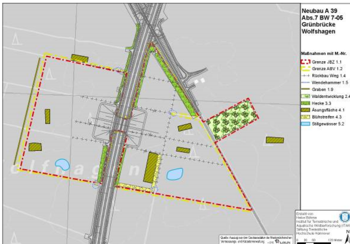
Abbildung 5: Maßnahmen im Bereich des Bauwerks 7-05
