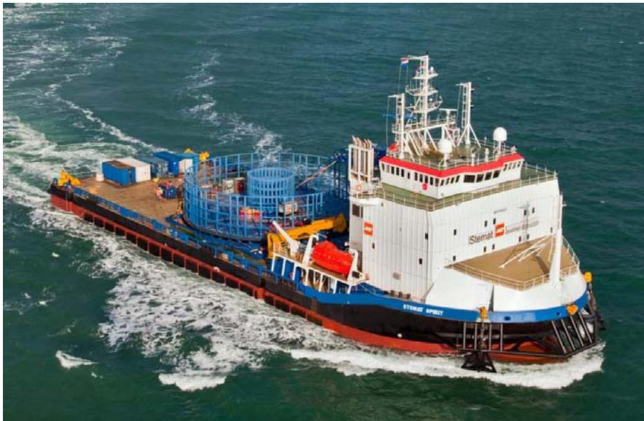
**Abbildung 9: Kabelverlegeschiff Stemat Spirit (Quelle: ABB)**
