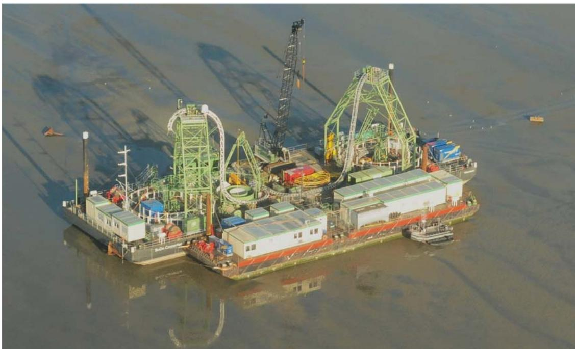
**Abbildung 18: Verlegebarge/Arbeitsponton mit Unterküften**
